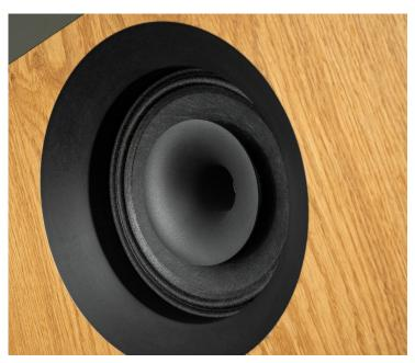
Für den Hoch- und Mittelton kommt ein neuer Koaxialtreiber mit Kugelwellenhorn zum Zuge. Hinter dem Horn agiert eine Polymer-Kalotte. Der von ihr erzeugte Schall wird durch den Trichter mit Traktrix-Formgebung homogen abgestrahlt. Aufgrund der koaxialen Anordnung der beiden Chassis agieren sie wie eine Ein-Punkt-Schallquelle – auch das befördert eine natürlichhomogene, räumliche Wiedergabe.
