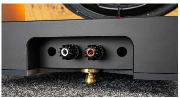
Die nextgen-Klemmen von WBT sind zugunsten der größtmöglichen Klangneutralität mit geringstmöglichem Metallanteil realisiert. Spatial Europe setzt hier auf die Version mit Kupfer-Kontakten. Ein Drehmoment-Indikator verhindert, dass die Klemmen beim Anschluss von Kabeln mit Schuhen zu stark angezogen werden. So wird ein optimaler Anpressdruck erzielt.
